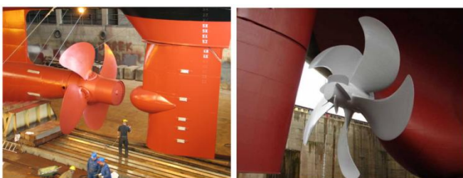
Fig.9. Propeller Cap Fin and Propeller Boss Cap Fins
