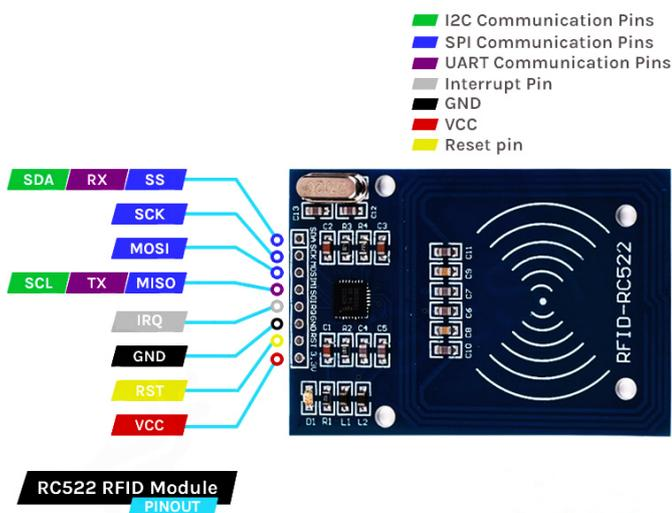
**FIGURE 1. RC522 RFID Module**
