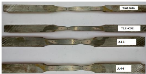
Fig. 4 SA 213 T12 Tensile Specimens After Testing
