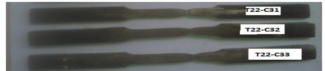
Fig. 5 SA 213 T22 Tensile Specimens After Testing
